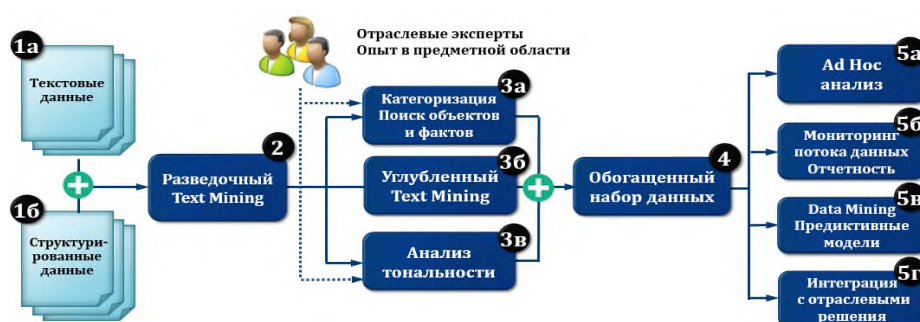
Рис. Типовая функциональная архитектура системы текстовой аналитики
